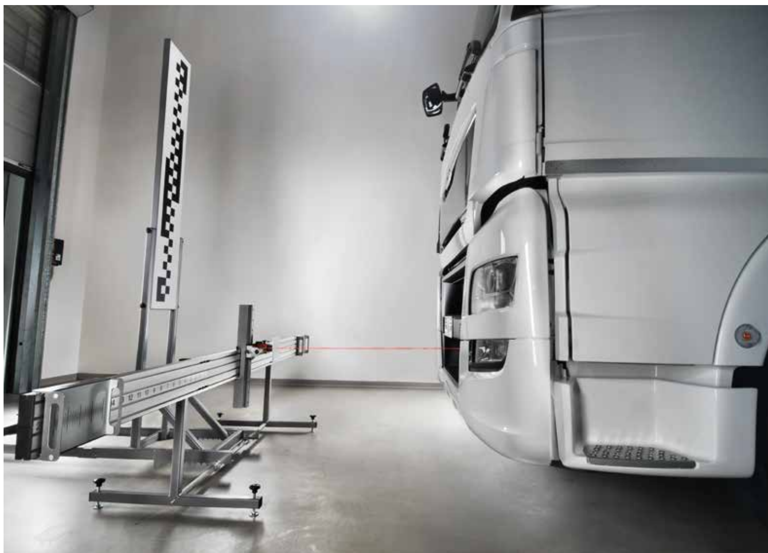
Magnetische Skala zur Kontrolle der Rahmengenometrie
