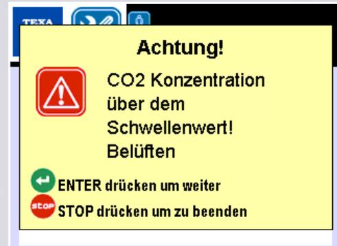
Die TEXA Software warnt den Anwender, wenn aufgrund des Ablassens von CO<sub>2</sub> aus der Anlage die Arbeitsumgebung nicht mehr sicher ist.
